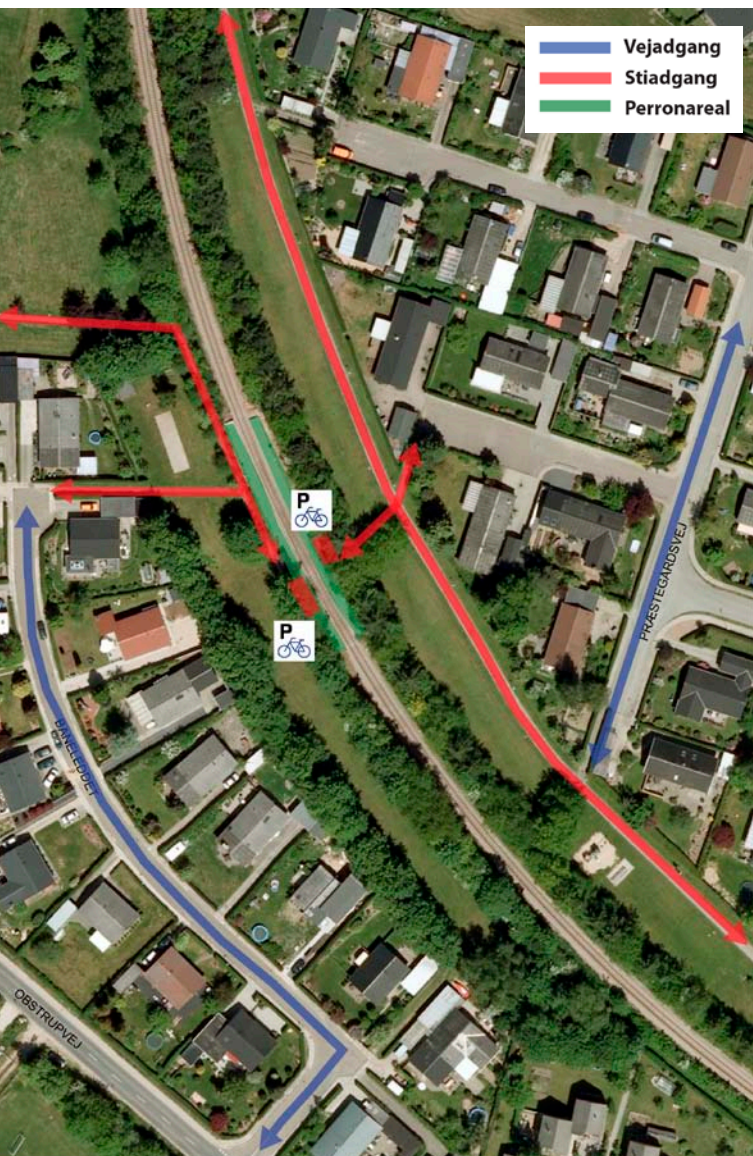
Nærområdet ved Mølleparken Station med angivelse af vej- og sti- adgange til stationsområdet, bil- og cykelparkering samt perronområde.
