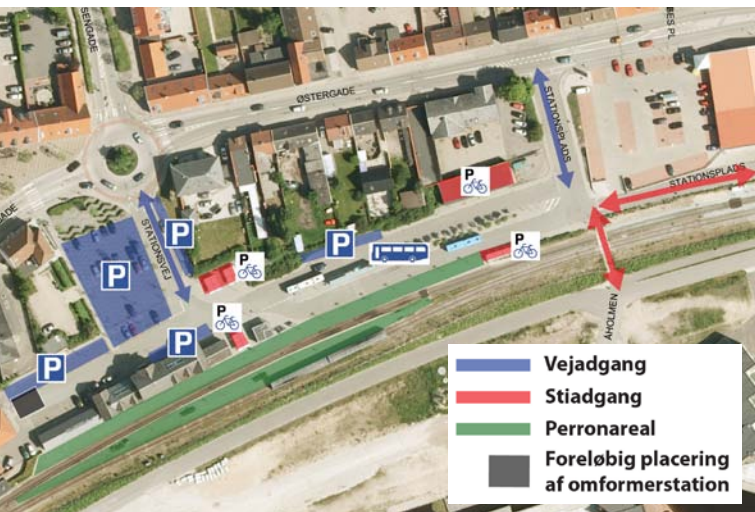
Nærområdet ved Grenaa Station med angivelse af vej- og stiadgange til stationsområdet, bil- og cykelparkering, perronområde samt den foreløbige placering af omformerstation.
